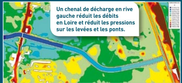
**Un chenal de décharge en rive gauche réduit les débits en Loire et réduit les pressions sur les levées et les ponts.**
