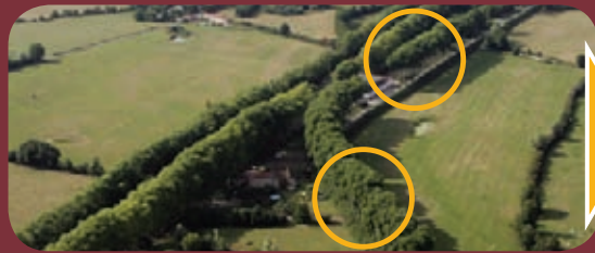
Levée de Sermoise, plusieurs brèches lors de la crue de 1790, 5 brèches d'une longueur totale de 415m lors de la crue de 1846, 1 brèche de 94 m lors de la crue de 1856, 1 brèche de 100 m lors de la crue de 1866
