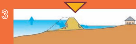
La crue est encore plus forte. La pression est très importante. Le pied de digue s'affaiblit progressivement côté Loire et côté aval avec des renards hydrauliques.
