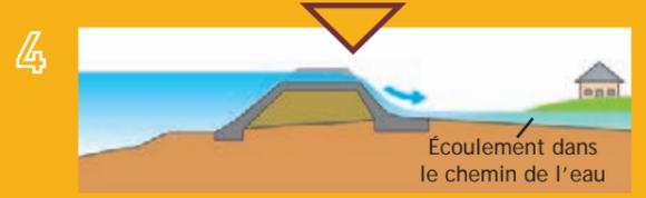
Plus la crue monte, plus le déversoir débite. La crue traverse le val au besoin en le remplissant. L'eau présente dans le val peut équilibrer la pression de la crue. Le pic de crue est écrété.
