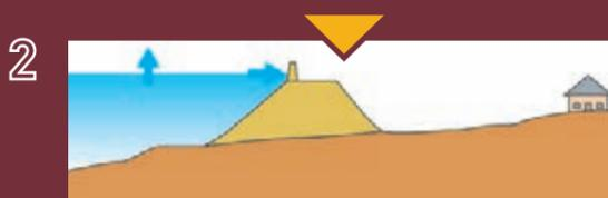
La crue attaque la banquette qui est instable car trop étroite. Le niveau de l'eau en Loire est surélevé par la présence de la banquette.
