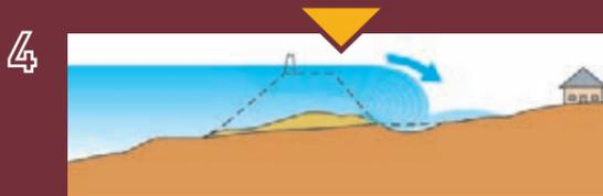
La digue cède d'un coup. C'est la brèche avec sa vague puissante et forte. Une fosse d'érosion est creusée derrière la digue. L'eau ouvre la brèche jusqu'au sol et érode la digue sur les côtés. La rivière est écrétée.
