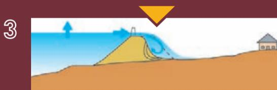
La banquette cède, la crue surverse la digue. Les flots érodent la digue côté val.
