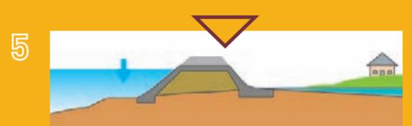
À la décrue, le déversoir cesse de fonctionner et le val se vide si un exutoire le permet.
