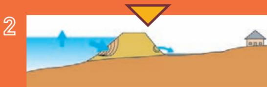
La crue érode le pied de digue insuffisamment protégé ou de mauvaise qualité. Des renards (infiltrations d'eau) traversent l'ouvrage, entraînant des matériaux de la digue.
