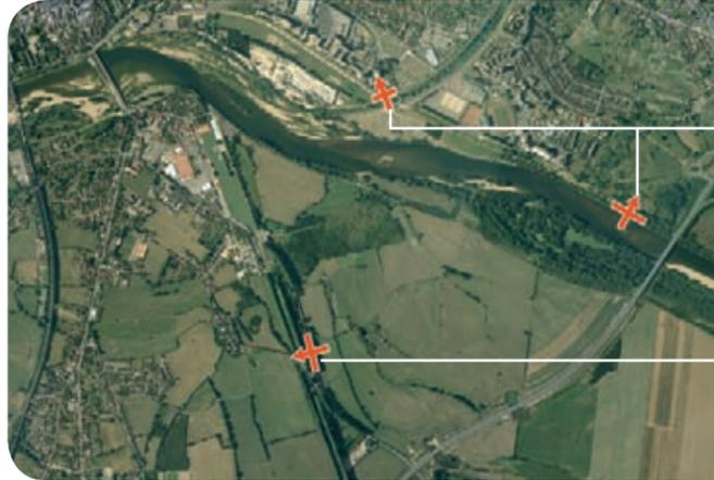
En rive droite, il serait nécessaire d'implanter deux déversoirs, en amont et en aval du canal de dérivation de la Nièvre. La configuration derrière les levées demande un pompage pour évacuer les eaux pendant et après la crue.
